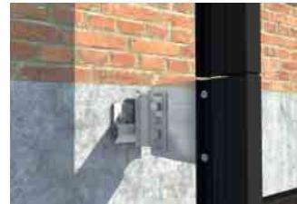
Die Traglisene der Modernisierungsfassade wird als vertikal gespanntes Tragsystem über eine Befestigungskonsole am Baukörper fixiert.
